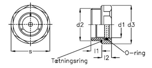
d1 = 11 d2 = G3/8 d3 = 22 l1 = 8 l2 = 7.5 Max pressure = -Max vacuum mbar = s = 20
